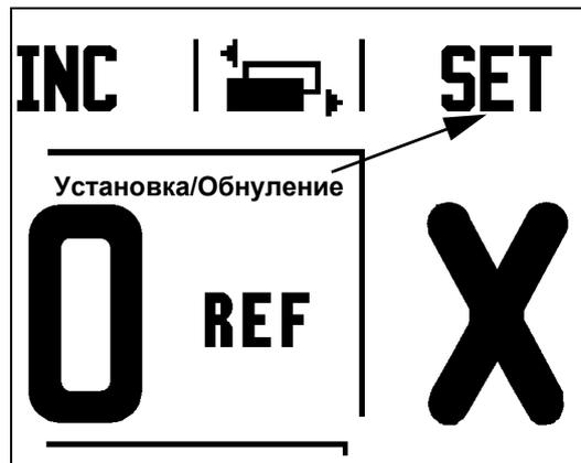
Рис. I.18 Индикатор страниц и режим Установки/Обнуления
