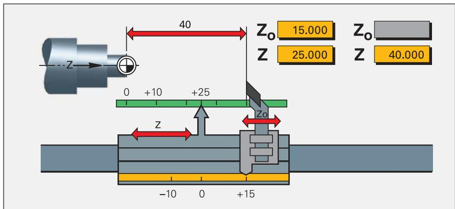
Отображение значения каждой/суммы осей на токарных станках с продольной и верхней осью
